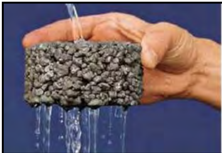
Figura 20 - Dispositivo de controle de escoamento – Pavimento poroso
